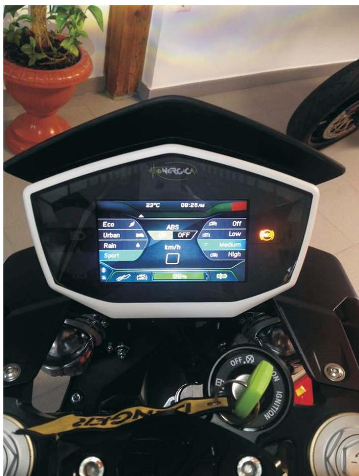
**Wie im Jet. Zentrale der Macht.** Wer will, kann zwischen Eco, Urban, Rain oder Sport wählen. ABS ein oder aus, Rekuperation aus, Medium, Low oder High. Und weitere Einblicke können von hier aus getätigt werden. Fast unnötig zu sagen, dass sie auch per modernem Smartphone kontrolliert werden kann.
